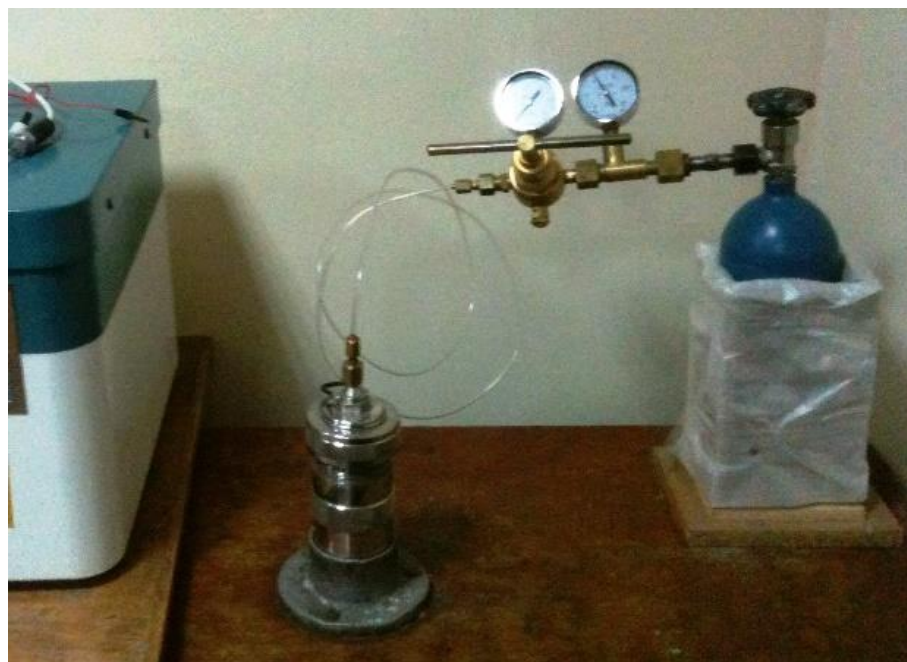
სურათი 15. მაღალი წნევის კონტეინერის ანგადათ შევსების სისტემა
