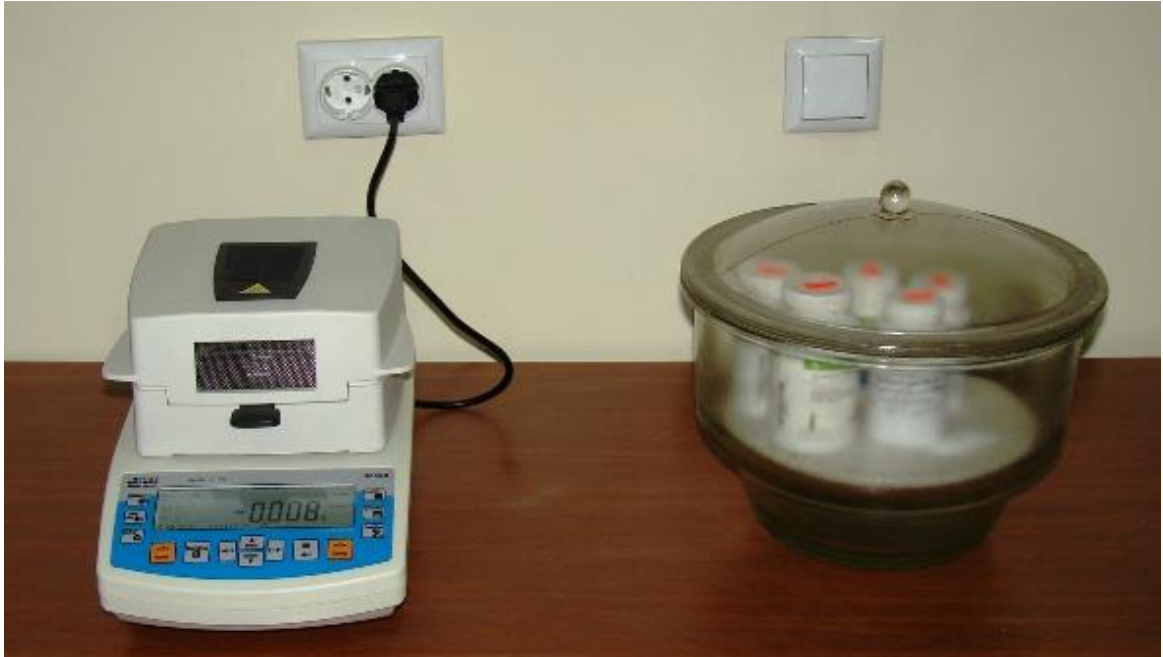
სურათი 17. სათბობის გამოსაშრობი დანადგარი RADWAG – MA 50.R და ექსიკატორი ნიმუშებით
