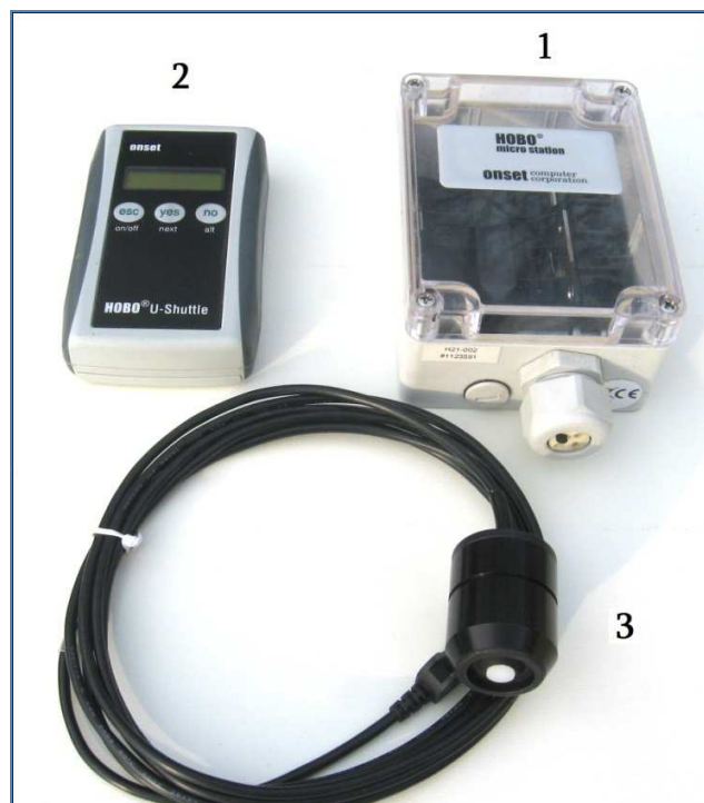
ნახ. 20. მონაცემთა ლოგერი – პარამეტრების გამზომი და ჩამწერი მოწყობილობა (1), მონაცემთა გადმომწერი მოწყობილობა (2) და მზის რადიაციის სენსორი (3).
