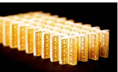
Метаматериал с отрицательным индексом преломления
