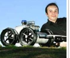
При помощи датчиков робот обнаруживает мины и обозначает их местоположение лазерным лучом. При создании своей машины Найдовски, прежде всего, старался сделать низкой стоимость робота: "Целью было построить что-то, имеющее очень низкую цену", - признается разработчик машины за \$500. Студент уже получил за свое создание приз от вице-канцлера Австралии.
