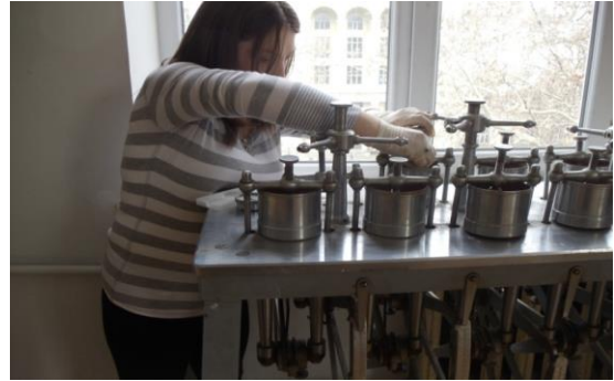
სურათები № 12 და № 13 გასამაგრებელი გრუნტის მომზადება კომპრესიისათვის.
