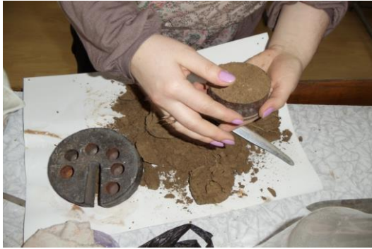
სურათები № 12 და № 13 გასამაგრებელი გრუნტის მომზადება კომპრესიისათვის.
