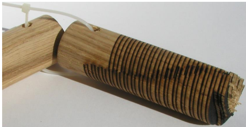
ნახ.19. 75 ვატის სიმძლავრის ლაზერით დამუშავებული ექსპერიმენტული საექსტრაქციო სპირალი
