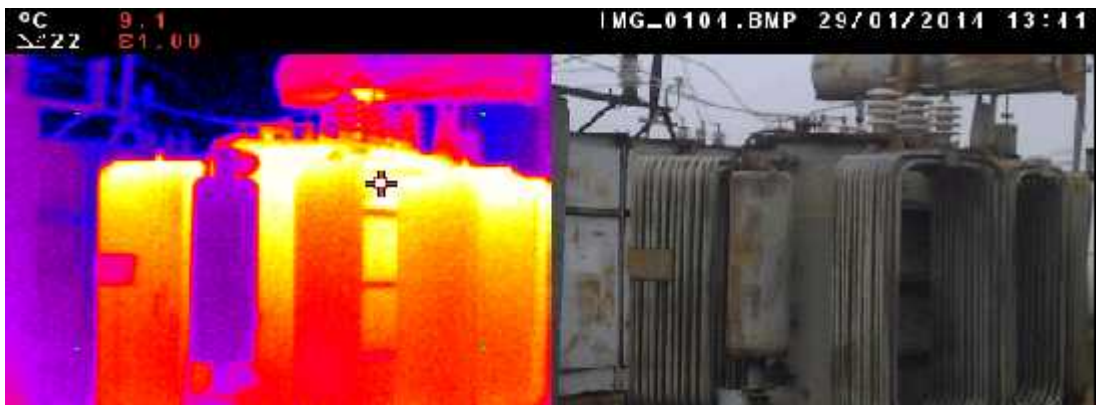
ნახ. №26 ქვესაღგური „კრწანისი“-ის ტ-2 ტრანსფორმატორის თერმოსიფონური ფილტრის თერმოგრამა
