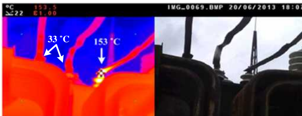
ნახ. №29 ქვესადგურ „საქასრია“-ს 10კვ ძაბვის შემყვანი იზოლატორის დეფექტური კონტაქტის თერმოგრაფია
