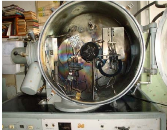
ნახ. 9. YBH75P3 დანადგარის ვაკუუმური კამერის შიგა მოწყობილობის ფოტოსურათი
