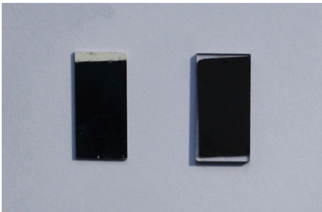
ნახ. 28. ჰოლმიუმის ტრიანთიმონიდის ფირები (ფუძეშრე მარცხნივ სიტალი - ფირის სისქე 1.0 მკმ, მარჯვნივ ლეიკოსაფირონი - ფირის სისქე 1.6 მკმ)
