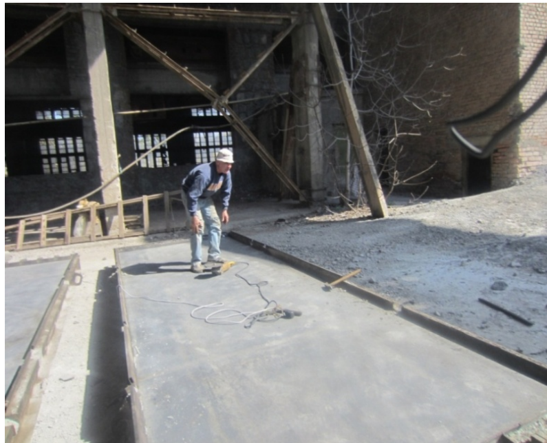
ნახ 2.1 წინასწარდამაბული ფილის ტექნოლოგიური ხაზი
