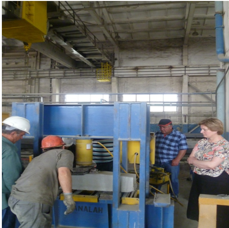
ნახ. 3.11 რკინაბეტონის შპალის გამოცდა
