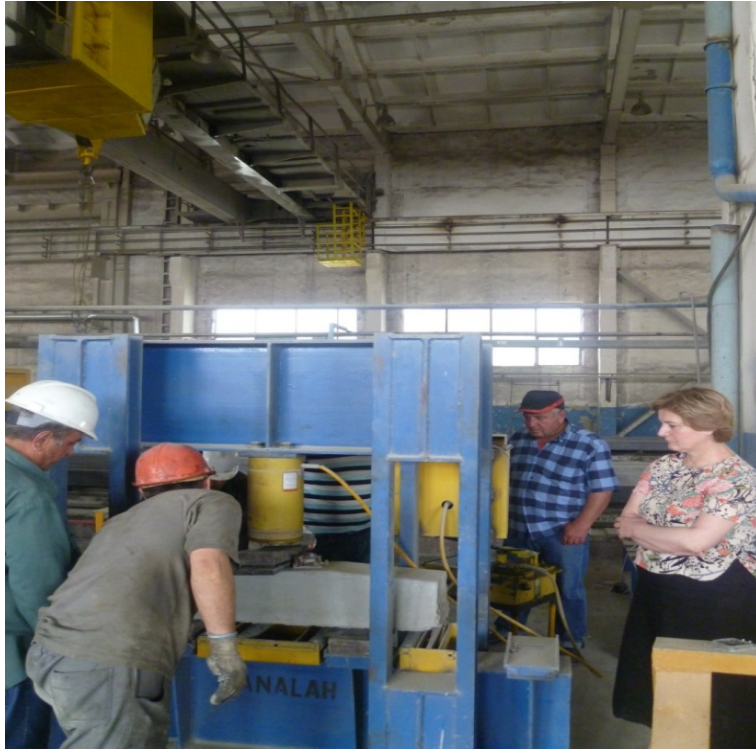
ნახ. 3.4 რკინაბეტონის შპალის გამოცდა
