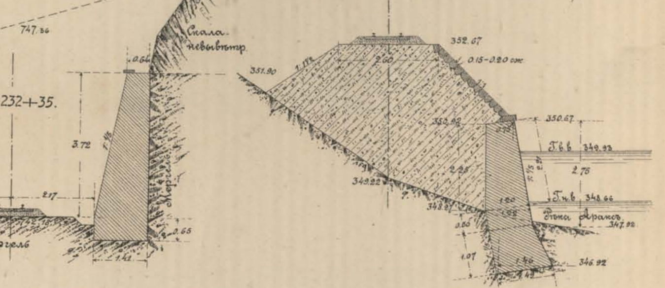
Выкладка насыпи изъ камня на пик. 105+30.20, версты 130. (Сисмаданская насыпь).
