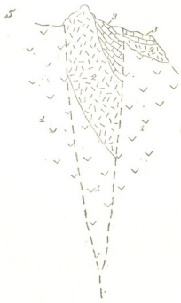
ნახ. 2. კვაისის სტრუქტურის სქემა. 1—პორფირიტული წყება; 2—ზედა იურული მასივური კირქვები; 3—ქვედა ცარცის შრეებრივი კირქვები და მერგელები
