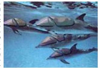
функционирует: способен нырять, лететь под водой, выскакивать из воды и исполнять различные акробатические трюки, которые не в состоянии исполнить, ни какое другое водное средство. Субмарина оснащена бензиновым двигателем на 110 л.с., марки Yamaha (PWC).
