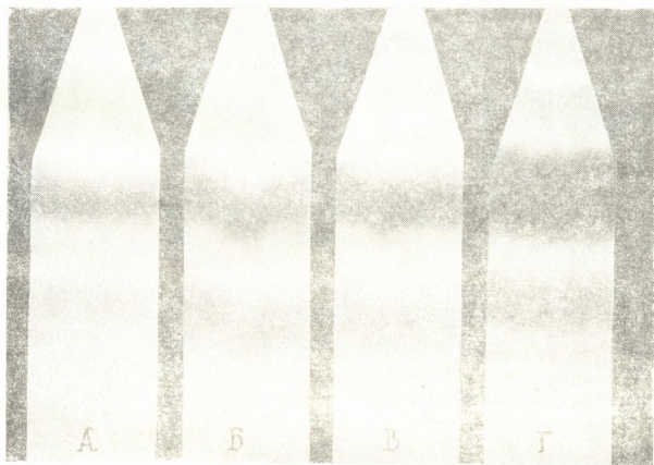
Рис. 1. Хроматограммы сахаров зеленого быстрорастворимого сухого концентрата чая: А — быстрорастворимый сухой концентрат из зеленого байхового чая; Б — быстрорастворимый сухой концентрат из III фракции отсортированного чайного листа машинного сбора; В — быстрорастворимый сухой концентрат из грубого листа осеннего сбора; Г — быстрорастворимый сухой концентрат из формовочного материала; а — рафиноза; б — сахароза; в — фруктоза
