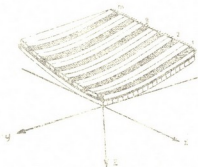
Рис. 1. Условное изображение двухслойной перекрестной расчетной модели вантовой сети, каждый слой которой содержит бесконечное множество изолированных друг от друга и закрепленных по концам гибких лент (показан один квадрант сети, имеющей две оси симметрии)
