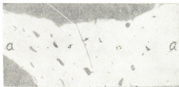
Рис. 2. Тот же сплав внешне однородного поля \text{Ni}_3\text{S}_2 при увеличении \times 1340
