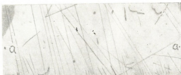
Рис. 4. Поле содержания меди в сплаве \text{Cu}_2\text{S}:\text{Ni}_3\text{S}_2=1,5:1 , отожженный при 750^{\circ}\text{C} и временем отжига 10 часов с предварительной закалкой
