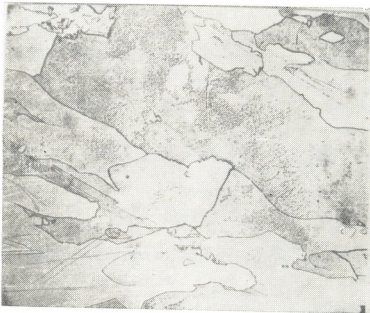
Рис. 1. Микроструктура сплава Si—Ge с содержанием галлия 0,4 вес % в исходном расплаве. \times 120
