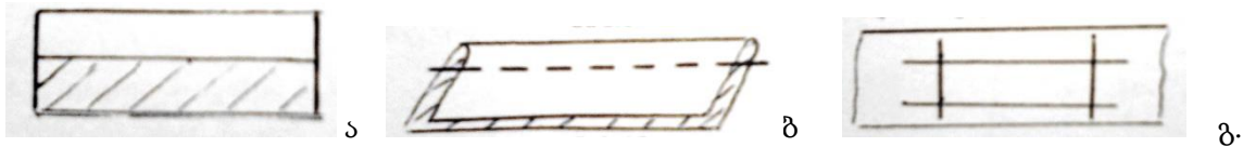
ნახ. 3.9. ა. წებოვან შეერთებული ფურცლაკი. ბ. გასაფორმებელ გვირისტ გატარებული ფურცლაკი. გ. ჯიბის ადგილის აღნიშვნა
