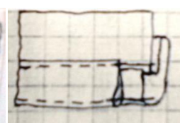
ნახ. 1.4. ა. შარვლის ბიჯის განაჭერი ნაპირების შეერთება. ბ. შარვლის ბოლო ნაპირის დამუშავება სხვადასხვა მეთოდით.
