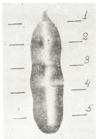
Рис. 2. Монокристалл Ga Sb + Al: 1— \rho = 1,2 \cdot 10^{17} \text{см}^{-3} , R_{\sigma} = 400 \text{см}^2/\text{в сек} ; 2— \rho = 1,38 \cdot 10^{17} \text{см}^{-3} , R_{\sigma} = 650 \text{см}^2/\text{в сек} ; 3— \rho = 1,42 \cdot 10^{17} \text{см}^{-3} , R_{\sigma} = 680 \text{см}^2/\text{в сек} ; 4— \rho = 1,65 \cdot 10^{17} \text{см}^{-3} , R_{\sigma} = 530 \text{см}^2/\text{в сек} ; 5— \rho = 1,7 \cdot 10^{17} \text{см}^{-3} , R_{\sigma} = 380 \text{см}^2/\text{в сек}
