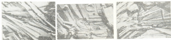
Рис. 2. Структура гипса после термовлажностной обработки: а, б — после завершения термовлажностной обработки, в — через 28 суток хранения в воде
