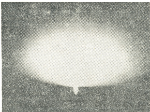
Рис. 2. Электронограмма поверхности арсенида галлия, облученного ионами фосфора ( \Phi = 10^{15} \text{ р}^*/\text{см}^2 ). 30' касание электронного луча. Ускоряющее напряжение 75 \text{ КВ} .
