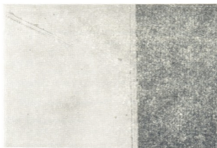
Рис. 1. Микрофотография поперечного среза германиевой n^+ - p -структуры ( \times 1000 )
