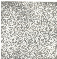
Рис.3. Изображение распределения серы на поверхности пленки \text{Tm}_2\text{S}_3 в рентгеновских лучах (x400)
