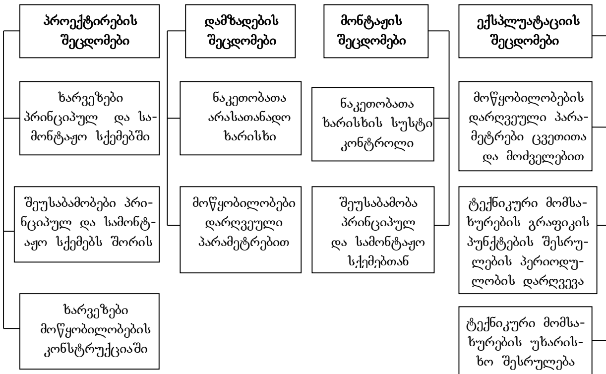
ნახ. 2 პროექტირების, დამზადების, მონტაჟისა და ექსპლუატაციის დროს დაშვებული, სატ მოწყობილობების უწყისივრობების გამომწვევი შეცდომები.
