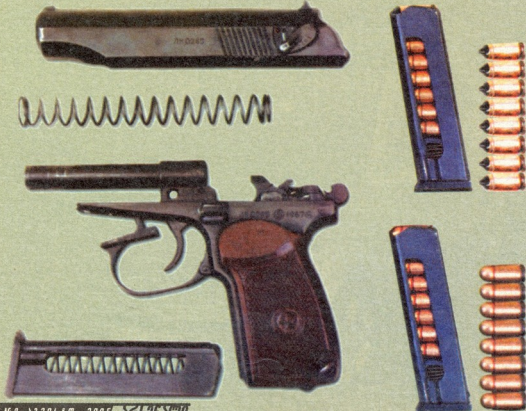
მაკაროვის იარაღულად დაშლა და მისი ვაზნები. ძველი 9X18 PM (ქვემოთ) და თანამედროვე 9X18 PM.
