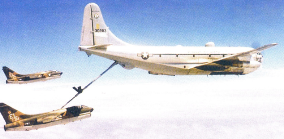
KC-97 მსოფლიოში პირველი მფრინავი ტანკერი იყო, რომელიც გამართვის სრულიად განსხვავებული — ხისტი სისტემით იყო აღჭურვილი. ფოტოზე KC-97 A-7 Corsair-ებს მართავს
