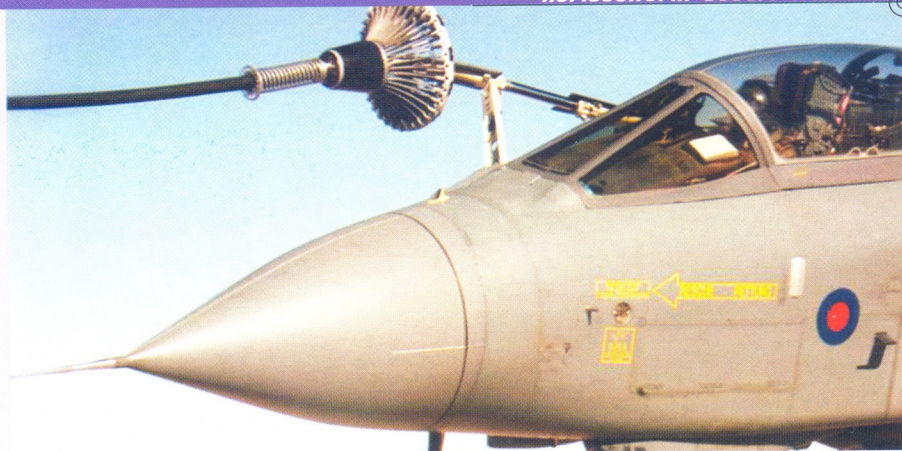
ამ ფოტოზე საკმაოდ კარგად ჩანს შლანგი-კონუსის სისტემის მეშვეობით ბრიტანულ Tornado-ს გამართვის დეტალები — მისი მიმღები ძელი და მასთან შეერთებული კონუსი.
