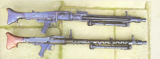
ვიზუალურად MG-42 (ზემოთ) MG-34-ისგან (ქვემოთ) ლულის გასაცვინებელი ცხაურის კონსტრუქციითაც განსხვავდებოდა
