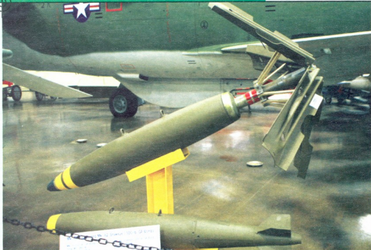
Mark-ის სერიის უმართავი ბომბების ეფექტურობის გაზრდის მიზნით ამერიკელები სხვადასხვა საშუალებებს მიმართავენ. ზედა ფოტოზე Mk 82 Snake Eye-ის ტიპის ბომბები გასასწვრივ აუდიო ქვედაზე — იგივე კლასის ბომბი კუდაში არსებული საპარაშუტო სისტემით
