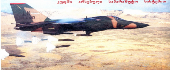
Mark-ის სერიის უმართავი ბომბების ეფექტურობის გაზრდის მიზნით ამერიკელები სხვადასხვა საშუალებებს მიმართავენ. ზედა ფოტოზე Mk 82 Snake Eye-ის ტიპის ბომბები გასასწვრივ აუდიო ქვედაზე — იგივე კლასის ბომბი კუდაში არსებული საპარაშუტო სისტემით
