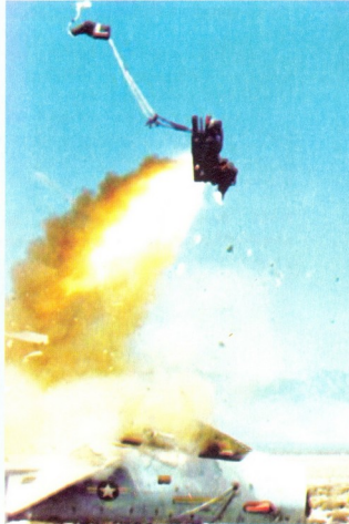
ავარიულ სიტუაციაში კატაპულტირებადი საფარძელი მფრინავის გადარჩენის უკანასკნელი იმედი, ამიტომაც თვითმფრინავზე დაყენებამდე მისი 100%-ით გამოცდა ხმელეთზე ხდებოდა
