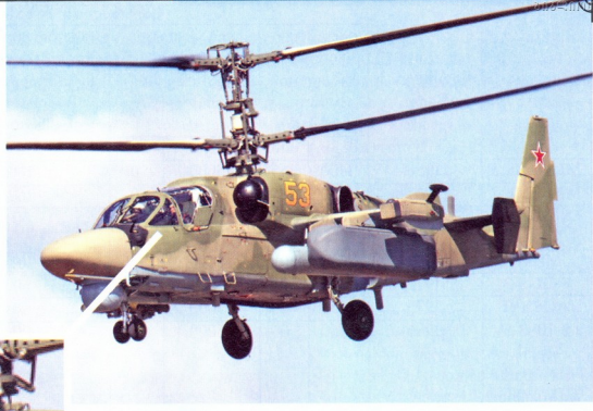
Ка-52 მსოფლიოში იმ ორ შვეულმფრინავთანაა, რომელზეც კატაპულტირების სისტემა გამოიყენება. გადიდებულ ფოტოზე ნათლად ჩანს ფარანზე განლაგებული პირატრეკტორული გვარდი და მფრინავის სავარძლის უკან არსებული თეთრი ცილინდრი, რომელშიც რაკეტული ძრავაა განთავსებული
