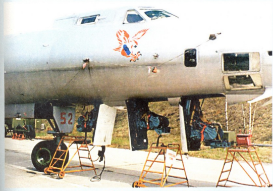
სავიაციო KT-1, მისი Ty-22-ზე განთავსების საკმაოდ თვისებური სქემის გამო (კატაპულტირება რეჟიმით) ხდებოდა, რაც ყოველთვის ვერ უზრუნველყოფდა ეკიპაჟის გადაარჩენას
