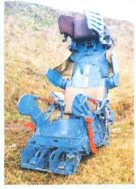
სავიაციო KT-1, მისი Ty-22-ზე განთავსების საკმაოდ თვისებური სქემის გამო (კატაპულტირება რეჟიმით) ხდებოდა, რაც ყოველთვის ვერ უზრუნველყოფდა ეკიპაჟის გადაარჩენას
