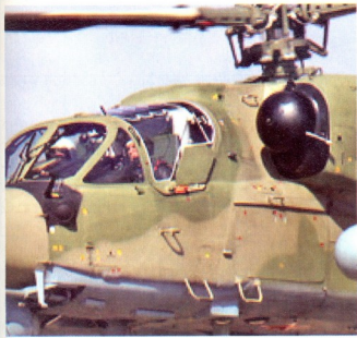
Ка-52 მსოფლიოში იმ ორ შვეულმფრინავთანაა, რომელზეც კატაპულტირების სისტემა გამოიყენება. გადიდებულ ფოტოზე ნათლად ჩანს ფარანზე განლაგებული პირატრეკტორული გვარდი და მფრინავის სავარძლის უკან არსებული თეთრი ცილინდრი, რომელშიც რაკეტული ძრავაა განთავსებული
