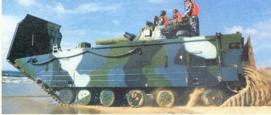
ZBD-2000: სელის მარავი - 500 კმ, სიჩქარე - 65 კმ/სთ-ში, შეიარაღლება - 30 მმ-იანი ავტომატი და 7,62 მმ-იანი ტყვიამფრტყევი
