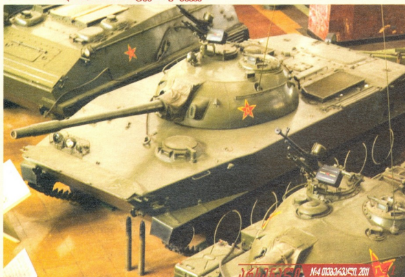
„ტიპი 63“: წინა - 18,5 ტონა, ძრავა - 240-ცხ.მალაინი, სელის მარავი - 260 კმ, სიჩქარე - 50 კმ/სთ-ში, შეიარაღლება - 85 მმ-იანი ქვემეხი, 7,62 მმ-იანი და 12,7 მმ-იანი ტყვიამფრტყევი
