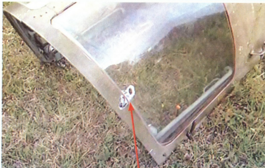
ცხინვალთან ჩამოვდებული რუსული Cy-25 კაბინის ფარანი ტყვიანი გვერდიან უპრობლემოდ გახვრიტა
