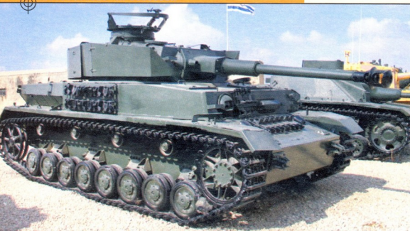
Pz Kpfw IVG: მასა — 23,5 ტონა, ჯგუშანი — 20-50 მმ, ეკიპაჟი — 5 კაცი, კარბურატორიანი 300-ცხ.ძალიანი ძრავა, სინქარე — 40 კმ/სთ-ში, სვლის მარაგი — 210 კმ, შეიარაღება — 75 მმ-იანი ქვემეხი და ორი 7,92 მმ-იანი ტყვიამფრქვევი
