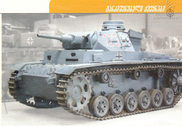
Pz Kpfw IIIH: მასა — 21,8 ტონა, ჯავშანი — 10-60 მმ, ეკიპაჟი — 5 კაცი, კარბურატორიანი 300-ცხ.ძალიანი ძრავა, სიჩქარე — 40 კმ/თ-ში, სვლის მარაგი — 165 კმ, შეიარაღება — 50 მმ-იანი ქვემეტი და ორი 7,92 მმ-იანი ტყვიამფრეველი
