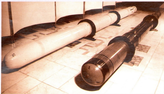
ეს უბოტერაიანი „მილები“ სინამდვილეში 40კტ ტროტილის სიმძლავრის რუსული ბირთვული ასაფეთქებელი მოწყობილობებია, რომლებსაც 2-3 კმ სიღრმის მატებაში უშვებენ და მათი აფეთქებით დეამაინის ქერქის სეისმურ ზონდირებას ახდენენ...
