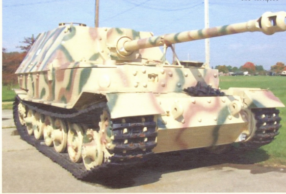
Ferdinand (Sd Kfz 184): მასა — 68 ტ, ეკიპაჟი — 6 კაცი, ჯავშანი — 45-200 მმ, კარბურატორიანი 2X600-ცხ.ძალიანი ძრავა, სიჩქარე — 20 კმ/თ-ში, სულის მარაგი — 150 კმ, შეიარაღება — 88 მმ-იანი ქვეშეშით და 7,92 მმ-იანი ტყვიამფრქვევი.
