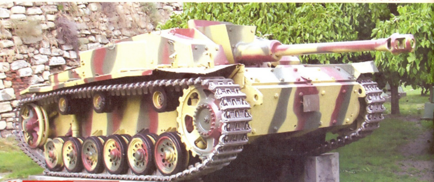
StuG III Ausf A: მასა — 21,6 ტ, ეკიპაჟი — 4 კაცი, ჯავშანი — 11-50 მმ, კარბურატორიანი 600-ცხ.ძალიანი ძრავა, სიჩქარე — 40 კმ/თ-ში, ხელის მარაგი — 140 კმ, შეიარაღება — 75 მმ-იანი ქვემეხი და 7,92 მმ-იანი ტყვიამფრეველი.
