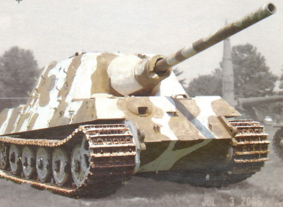
Jagdtiger (Sd Kfz 186): მასა — 71,7 ტ, კეიპაიუ — 6 კაცი, ჯავშანი — 40-200 მმ, კარბურატორიანი 700-ცხ.ძალიანი ძრავა, სიჩქარე — 34 კმ/სთ-ში, სვლის მარაგი — 80-120 კმ, შეიარაღება — 128 მმ-იანი ქვეშეში და 7,92 მმ-იანი ტყვიამფრქვევი.
