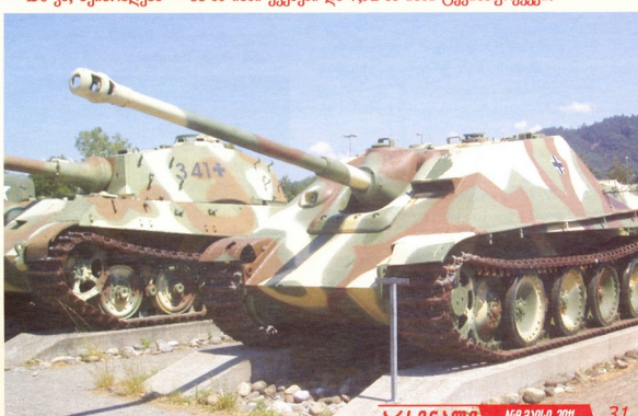
Jagdpanther (Sd Kfz 173): მასა — 45 ტ, ეკიპაჟი — 5 კაცი, ჯავშანი — 16-80 მმ, კარბურატორიანი 700-ცხ.ძალიანი ძრავა, სიჩქარე — 46 კმ/თ-ში, სულის მარაგი — 150 კმ, შეიარაღება — 88 მმ-იანი ქვეშეშით და 7,92 მმ-იანი ტყვიამფრქვევი.
