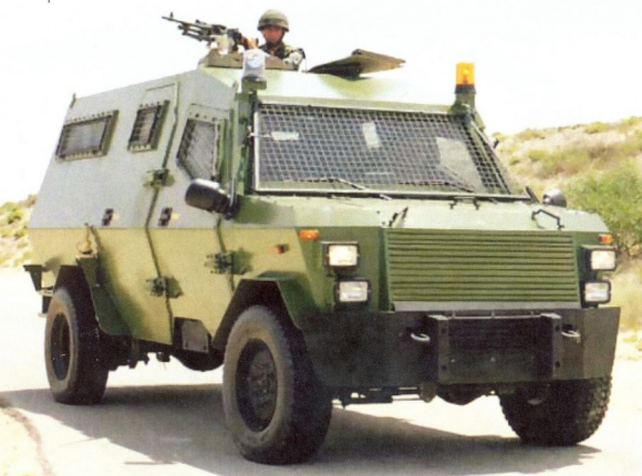
ებრაული ჯავშანმანქანა Wolf-ის ვიკაბი 2 კაცისგან, დესანტი კი 8 მებრძოლის-გან შედგება. მანქანას სიგრძე 5,7 მ, სიგანე 2,4, ხოლო სიმაღლე კი 2,35 მ-ია, მასა 8 ტონა-ს აღწევს, სადღანაც სასარგებლო დატვირთვა 1,5 ტ-ს შეადგენს
