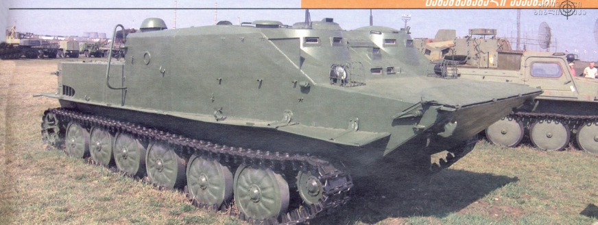
БТР-50ПК: მასა — 14,2 ტ, ეკიპაჟი — 2 კაცი, დესანტი — 20 კაცი, ჯავშანი — 6-10 მმ, დიზელის ძრვა — 240 ცხ. ძალიანი, სინქარე ხმელეთზე წყალში — 44,6/10,2 კმ/სთ-ში, სვლის მარაგი ხმელეთზე/წყალში — 260/70 კმ, შეიარაღება — 7,62 მმ-იანი ტყვიამფრექვე
