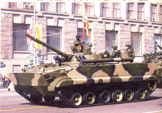
БМП-3: მასა — 19,0 ტ, ეკიპაჟი — 3 კაცი, დესანტი — 9 კაცი, დიზელის ძრავა — 500ც.ძალიანი, სინქარე ხმელეთზე/წყალში — 10-70/10 კმ/სთ-ში, სვლის მარაგი — 600 კმ, შეიარაღება — 100 მმ-იანი ქვემუხი, 30 მმ-იანი ავტომატური ქვემუხი, სამი 7,62 მმ-იანი ტყვიამფრქვევი და ტანკსაწინააღმდეგო მართავდი რაკეტები
