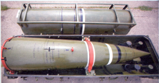
Tochka-Y-ს საბრძოლო ქობინი (მარცხენა ფოტო), რომელსაც ერევანში აღლუმზე ნაჩვენებ მულაქისგან (მარჯვენა ფოტო) განსხვავებით, არც კრილი და არც თავზე წამოცმული დაჭკვილი კონუსი აქვს
