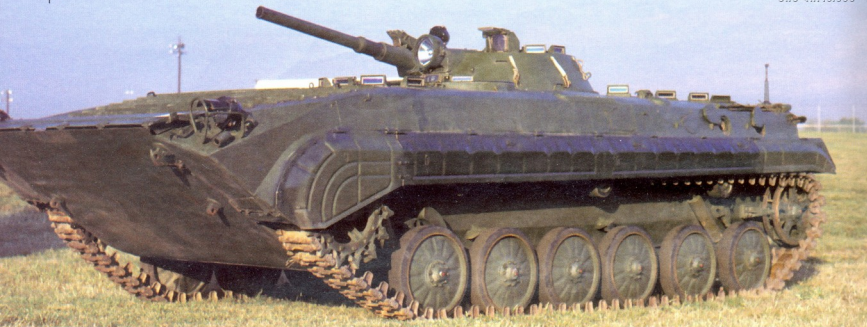
БМП-1: მასა — 13,0 ტ, ეკიპაჟი — 3 კაცი, დესანტი — 8 კაცი, ჯავშანი — 6-33 მმ, დიზელის ძრავა — 300ც. ძალიანი, სინქარე ხმელეთზე/წყალში — 44-65/7,0 კმ/სთ-ში, სვლის მარაგი — 550-600 კმ, შეიარაღება — 73 მმ-იანი ქვემუხი, 7,62 მმ-იანი ტყვიამფრქვევი და ტანკსაწინააღმდეგო მართავდი რაკეტები
