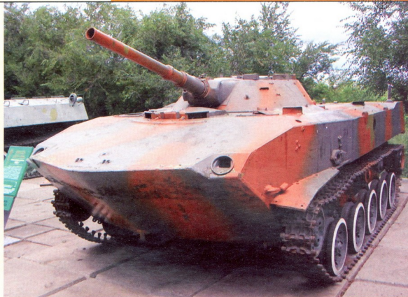
БМД-1: მასა — 7,2 ტ, ვეიბაიე — 2 კაცი, დესანტი — 5 კაცი, ალუმინის შენად-ნობის ჯავშინი, დიხელის მრავა — 240 ც.პალიანი, სიჩქარე ხმელეთზე/წყალში — 61/10 კმ/სთ-ში, სელის მრავაი — 500 კმ, შეიარაღება — 73 მმ-იანი ქვემჭი, სამი 7,62 მმ-იანი ტყვიამფრეველი და ტანკსაწინააღმდეგო მართეადი რაკეტები
