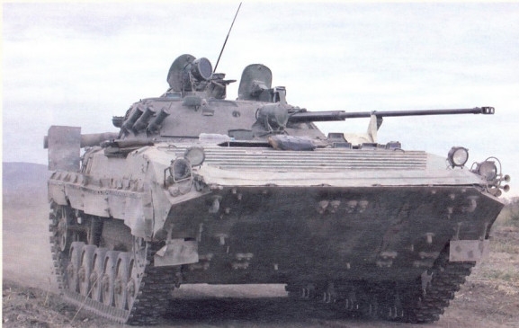
БМП-2: მასა — 14,0 ტ, ეკიპაჟი — 3 კაცი, დესანტი — 7 კაცი, ჯავშანი — 5-23 მმ, დიზელის ძრვა — 300 ცხ.ძალიანი, სინქარე ხმელეთზე/წყალში — 40-65/7,0 კმ/სთ-ში, სვლის მარაგი — 550-600 კმ, შეიარაღება — 30 მმ-იანი ავტომატური ქვეთქი, 7,62 მმ-იანი ტყვიამფრექვე და ტანკანონინაღმდეგო მართვადი რაკეტები
