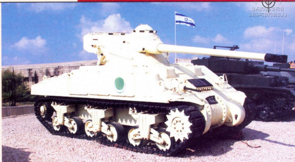
„შერმანის“ შიხი და მისზე დამყვანი ფრანგული მსუბუქი ტანკის AMX-13-ის ორიგინალური კონსტრუქციის მოქანავე ბოშკურა
