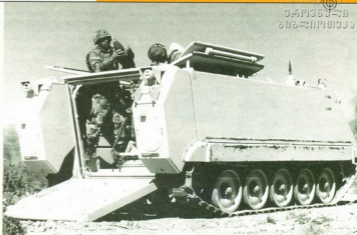
ამერიკლებმა ჯეკმანტრანსპორტორ M113-ს დაუყენეს არმიული 120 მმ-იანი ნაღმსატყორცი და მიიღეს თვითმავალი დანადგარი M1064
