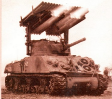
ამერიკული ტანკს Sherman-ის საფუძველზე დამზადებული 114 მმ-იანი ზალბური ცეცხლის რაქტული სისტემა T34 Callipe
