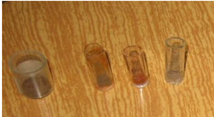
სურათი 18. გამოცდისათვის განკუთვნილი შუშის მილისგან დამზადებული სინჯარები
