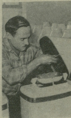
ქარხანა „თბილგაზაპარატის“ ამწყოები სამჭროს ჯეინკალი გ. ხარატიშვილი უკვანსენლად ათვადიერებს ქარხნის მიერ გამოშვებულ გაზი წყლის გასაბობო კოლონებს.
