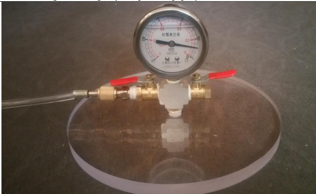
Рис. 3. Крышка с вмонтированным барометром.
