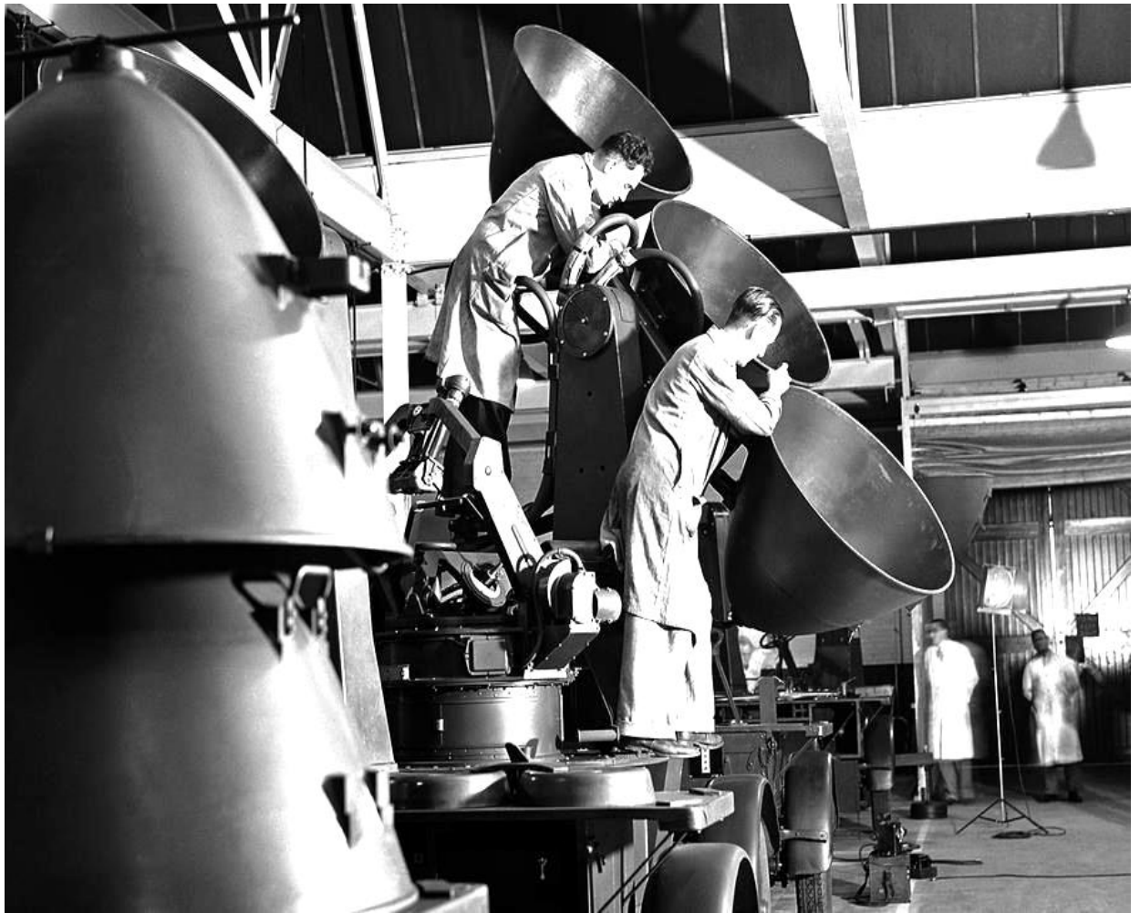
ჰაერსაწინააღმდეგო თავდაცვის ბატარეების აღჭურვისათვის საჭირო ხმის პარაბოლოიდური დეტექტორების აწყობა ინგლისის ერთ-ერთ ქარხანაში. 1940 წლის 30 ივლისი
