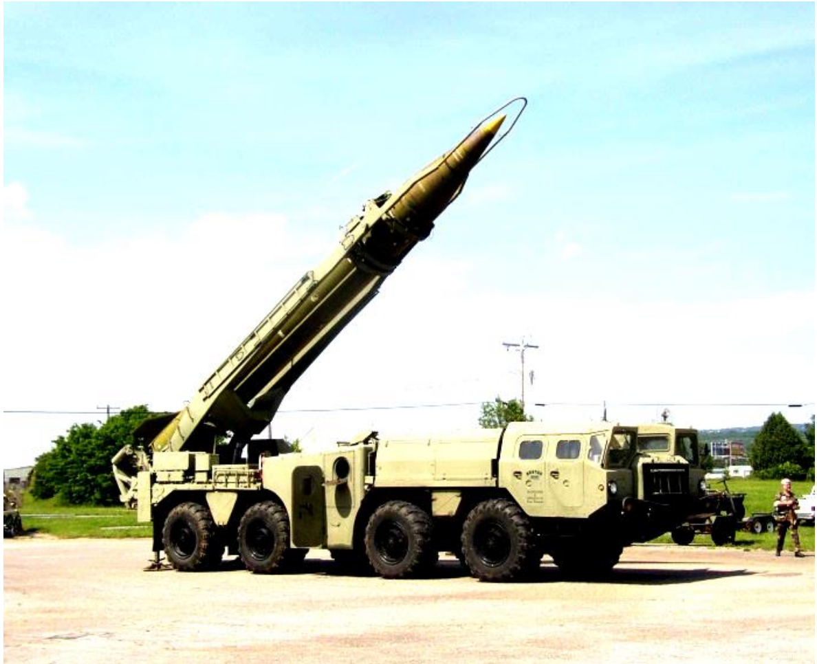
„ხმელეთი-ხმელეთი“ ტიპის საბჭოური წარმოების ტაქტიკური დანიშნულების ბალისტიკური რაკეტა P-17, NATO-ს კლასიფიკაციით SS-1, SCUD
