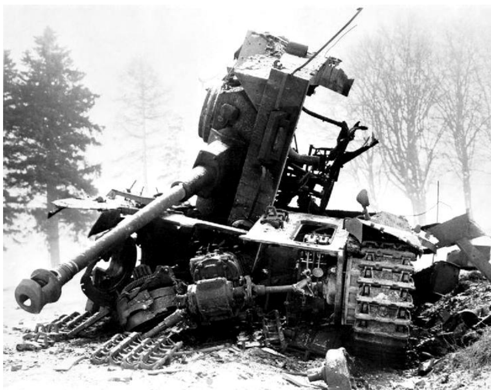
გერმანული „ვეფხვი“. მოგლეჯილი კოშკურა, საბრძოლო კომპლექტის დეტონაციისგან ტანკის გაგლეჯილი კორპუსი და მიწაზე დაგდებული გადაცემათა კოლოფი მიუთითებს იმ გააფთრებულ თავდაცვით ბრძოლებზე, რასაც ამერიკელები აწარმოებდნენ არდენის ოპერაციის დროს
