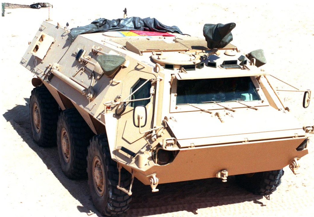
M-93 Fox – ამერიკული წარმოების რადიოაქტიური, ქიმიური და ბიოლოგიური (რქბ) დაზვერვის ტრანსპორტიორი, რომელიც ფართოდ გამოიყენებოდა ოპერაცი „უდაბნოს ქარიშხლის“ დროს
