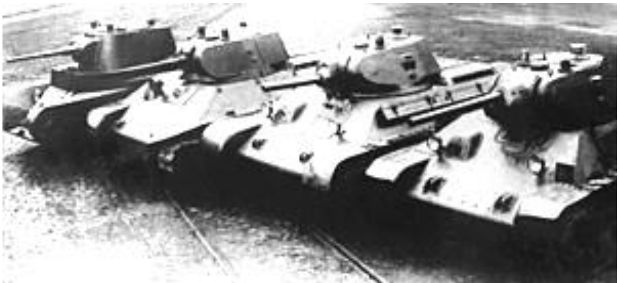
T-34-ების ოჯახი. ქარხანა №183-ში წარმოებული საბჭოთა ტანკები. მარცხნიდან მარჯვნივ: A-8 (BT-7M), A-20, 1940 წლის ნიჟუშის T-34 JI-11 ქვემეხით, 1941 წლის ნიჟუშის T-34 Φ-34 ქვემეხით
