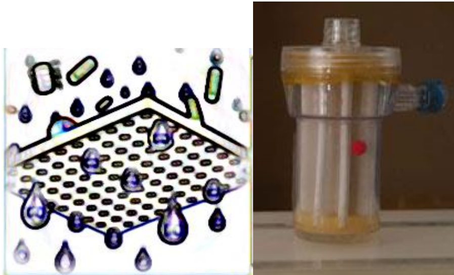
ნახაზი 3. აპარატი მემბრანული ფილტრაციისთვის, რომელშიც მოთავსებულია კერამიკული ფილტრები
