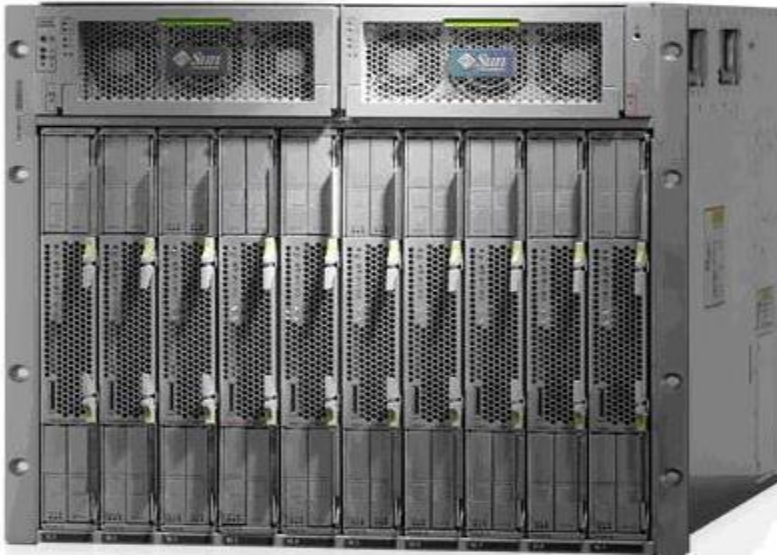
ნახ. 6. ტიპური 10U კომპიუტერის სალტე10 Blade -სერვერისათვის ( Sun blade 6000 ). http://imexresearch.com/newsletters/sunblade6000c7-17.htm
