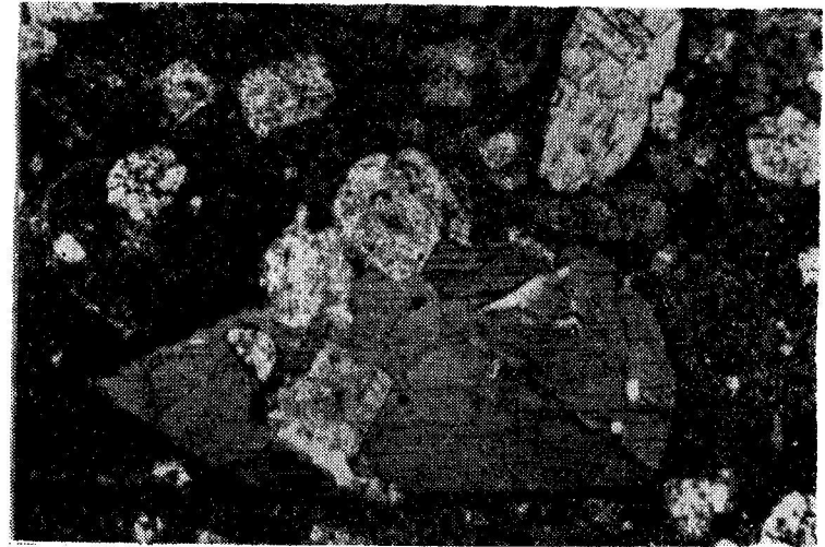
სურ. 5. რქატყუარიანი პორფირიტი. რქატყუარა ოპაციტიზებულია, მასში მოქცეულია ლაბრადორის მიკროფენოკრისტალები. მდ. ჯონოულას ხეობა. X 28. ნიკ. ||
