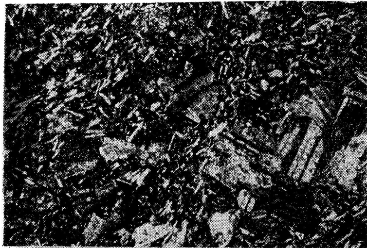
სურ. 4. გააღბიტებული პორფირიტი. მინდალინებში — ქლორიტი და კალციტი. მდ. ტეხურის ხეობა. X 30. ნიკ. +
