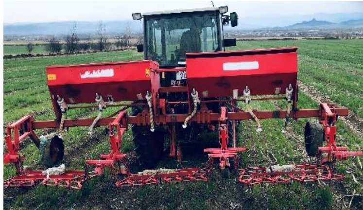
სურ.1. მოდერნიზირებული რიგთაშორისების კულტივატორი „ლგმკ-4,5/3“
