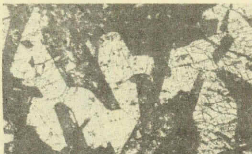
Рис. 5. Разрушенный рассланцованный диабаз, превращенный в плотный микроагрегат смеси хлорита, кварца, гидроокислов железа и других минералов. Плаггиоклаз пренитизирован. Обр. 40, Ник, П, ув. 70. Ущ. р. Ассы
