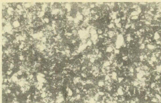
Рис.8. Разнозернистый, средне-мелкозернистый слюдисто-плагиоклазово-кварцевый песчаник с мусковит-кварцевым цементом. Обр.5. Ник.Х, ув.30. Ущ.р.Асси
