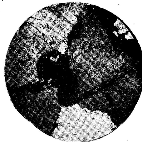
Рис. 6. Микроструктура кварца Рквийского гранита. Видна степень раздробленности кварца, большое количество жидких и газовых включений.
