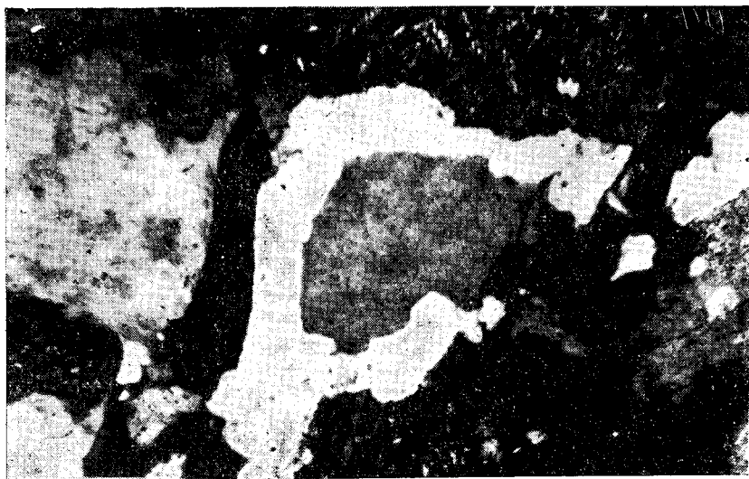
Рис. 13. Обрастание кварца кварцем с образованием «двузонального» кварца. Ник.+, увел. 40.
