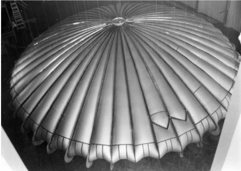
ფიგ. 26 – კოსმოსური გასაშლელი, 15 მეტრი დიამეტრის პნევმოხისტი გუმბათოვანი კონსტრუქცია, რომელიც მყარდება კოსმოსურ გარემოში
