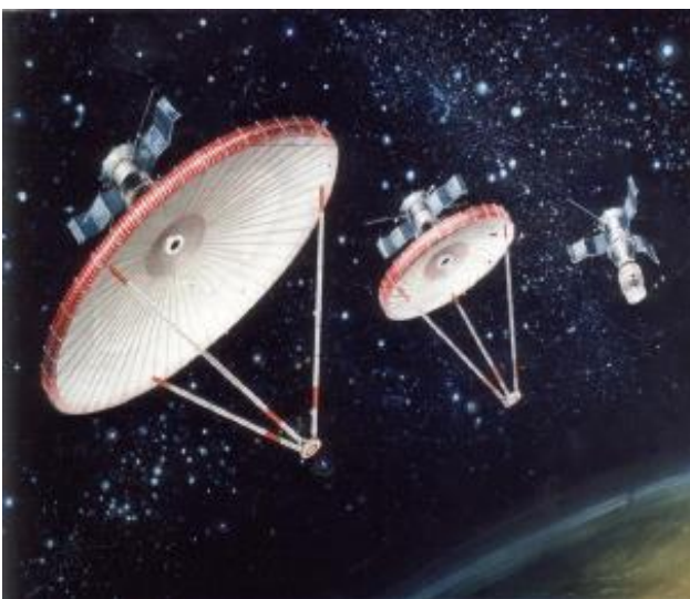
ფიგ. 27 – ორბიტაზე განთავსებული კოსმოსური დაჯგუფების შემადგენელი თანამგზავრული კომპლექსი, აგებული დიდი გასაშლელი, პნევმოხისტი რეფლექტორის ბაზაზე
