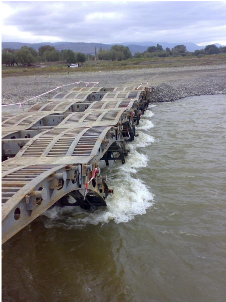
ფიგ. 52 – ხიდი KM-02T მრავალგზის იქნა გამოყენებული სამოქალაქო ექსტრემალურ სიტუაციებში, მათ შორის რუსეთ-საქართველოს ომის შემდეგ, მდინარე მტკვარზე, გორის რაიონში დევნილების დასახლების მშენებლობისას.
