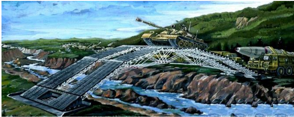
ფიგ. 4 – საიერიშო, მექანიზებული, გასაშლელი ხიდი – გამოგონება გრიფით “საიდუმლო” – A.C. СССР № 109303, 4.10.1976 г.
