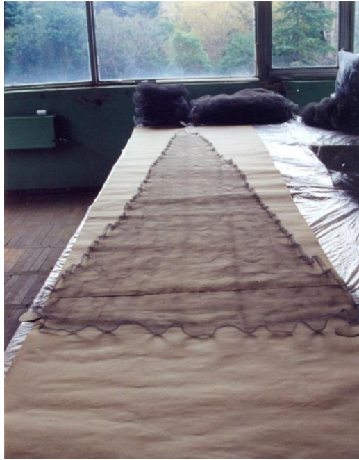
ფიგ. 45 – რეფლექტორის ამრეკლი ზედაპირის ერთი სექტორისათვის ბადის წინასწარი ნამზადი დაუჭიმაგ მდგომარეობაში
