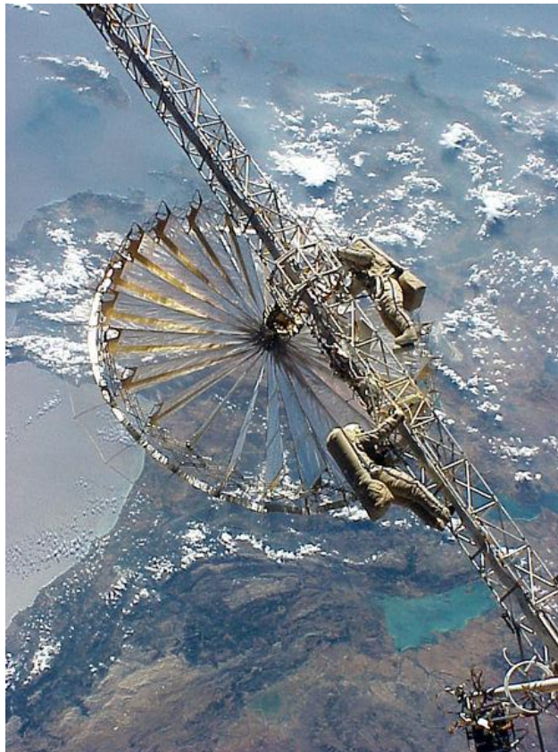
ფიგ. 117 – რეფლექტორის ორბიტული სადგურიდან ჩამოცილების წინა მომენტში, კოსმონავტები ამოწმებენ რეფლექტორის კოსმოსურ აპარატთან პერიფერიული ზონის ჩამაგრების შესაძლებლობებს, ძირითადად განპირობებულს კონსტრუქციის დიდი სიხისტით.
