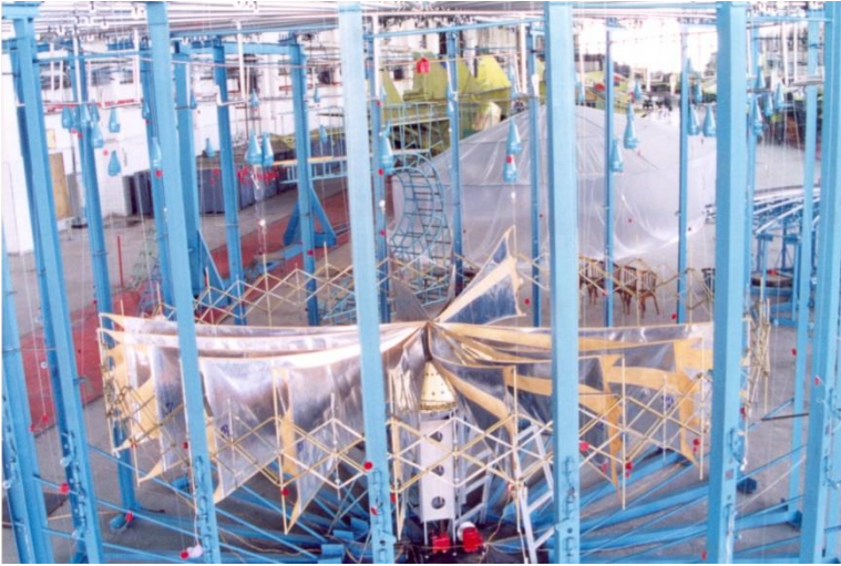
ფიგ. 53 – ფურცლოვანი წიბოების მონტაჟი. მისი მიერთება გამშლელ რგოლთან და ცენტრალურ დოლთან, რომელიც კონუსურ ფუძეზეა მიმაგრებული.
