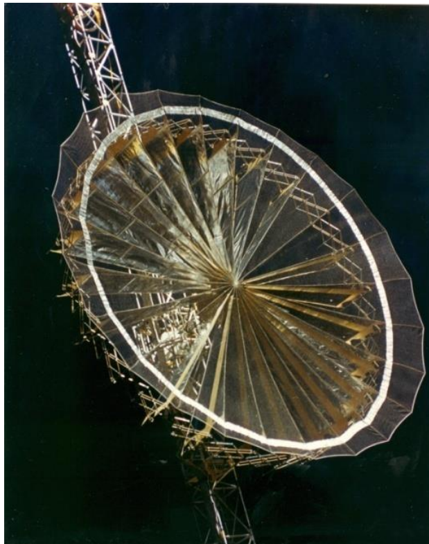
ფიგ. 114 – კოსმოსური რეფლექტორის ღია კოსმოსურ სივრცეში გაშლის ტრანსფორმაციით ფორმათწარმოქმნის პროცესი დასრულდა, რვა პრაგა გაითიშა და ფორმა ფიქსირებულია.
