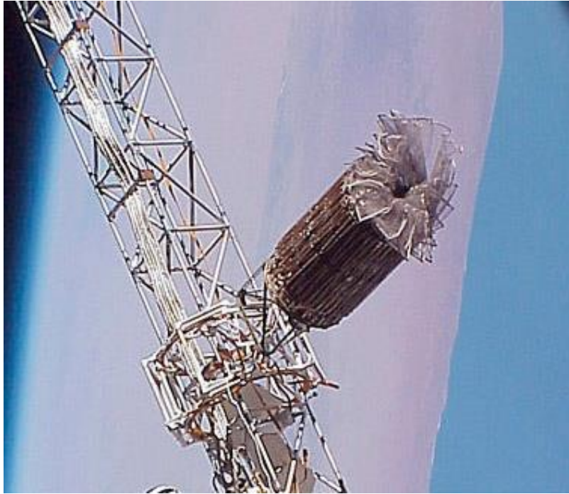
ფიგ. 110 – ორბიტულ სადგურ “მირ“-ზე კოსმოსური ობიექტი მიმაგრებულია კონსტრუქცია „სოფორა“-ზე და იგი მზად არის გასაშლელად
