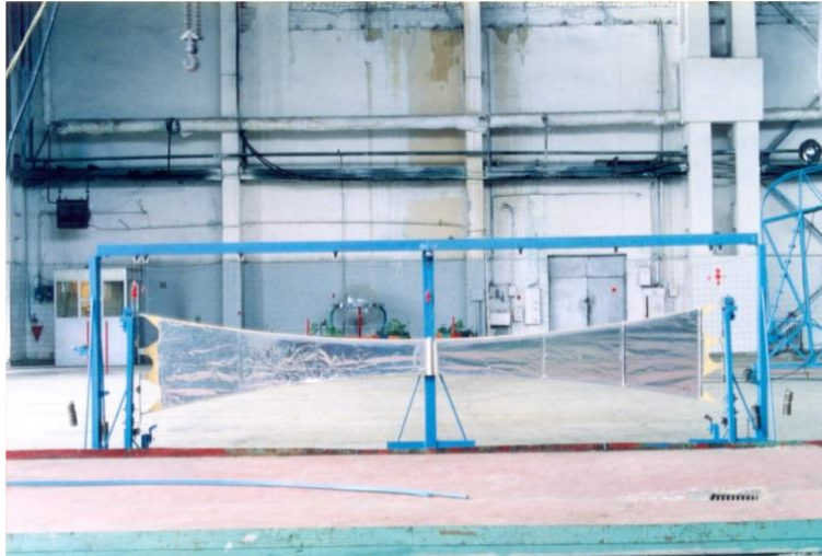
ფიგ. 42 – რეფლექტორის, ცენტრალური ნაწილის გაჭიმულ ფურცლებზე დამაგრებულია ფურცლის მიმართ ვერტიკალურად განთავსებული სიხისტის წიბოები
