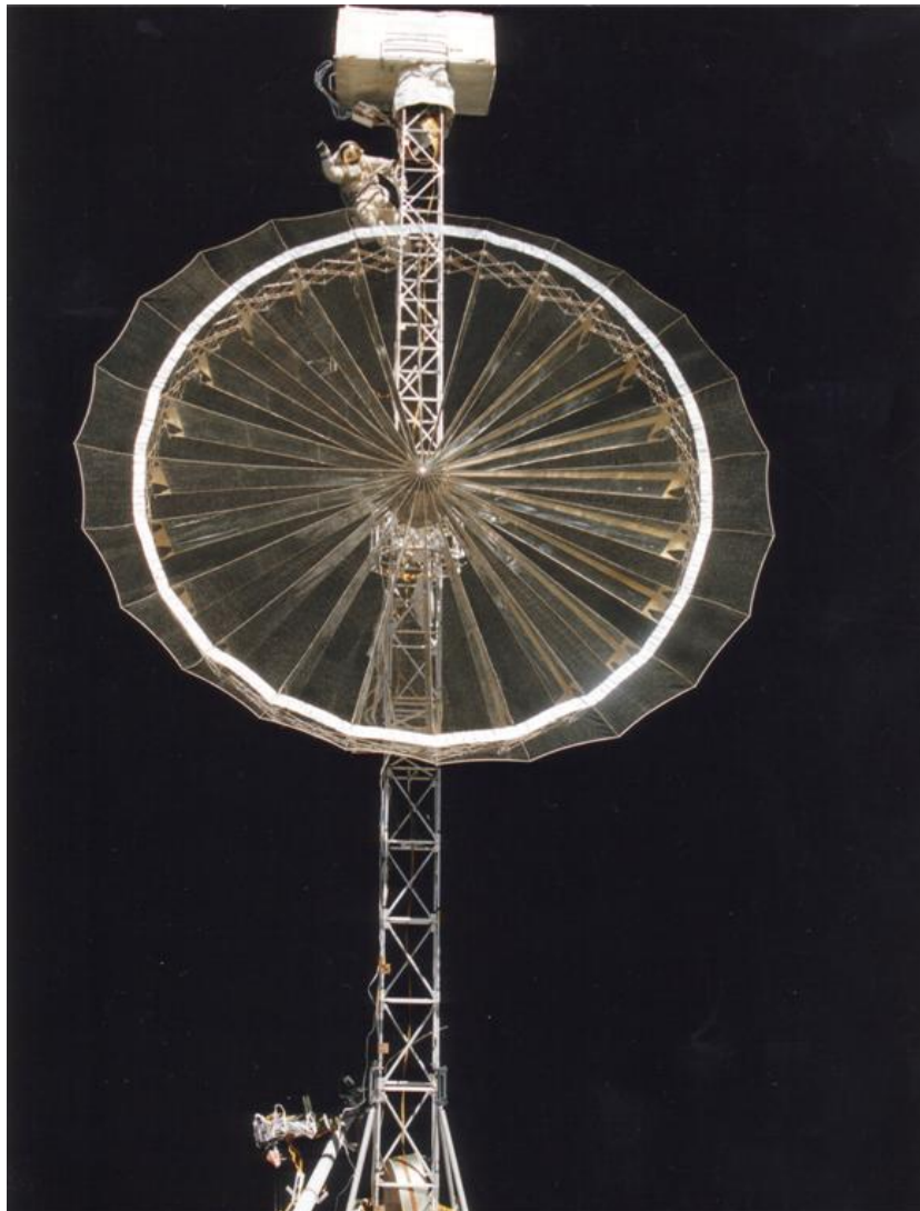
ფიგ. 115 – გაშლილი რეფლექტორი, მიმდგრებული კონსტრუქცია “სოფორა“-ზე. სურათზე ასევე ჩანს კონსტრუქცია “სოფორას” საბაზო, ორბიტულ სადგურ “მირ“-თან მიერთების სისტემა, მის დაბოლოებაზე განთავსებული, კოსმოსური სადგურის ორიენტაციისა და მართვის პარამეტრების გაზრდისათვის დამონტაჟებული რეაქტიული ძრავების კონტეინერი და თვით კოსმონავტი, რომელიც იყო რეფლექტორის გამოცდების მონაწილე.
