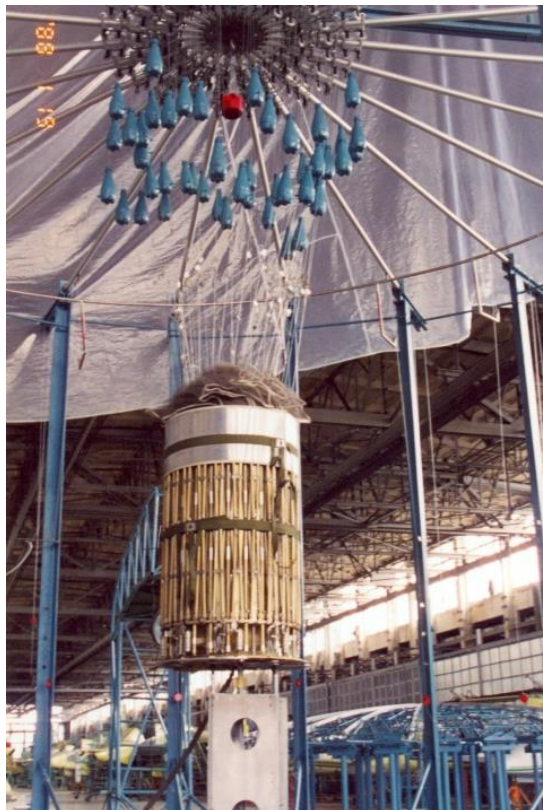
ფიგ. 75 – რეფლექტორის საფრენოსნო ვარიანტის დაკეცილი სატრანსპორტო პაკეტი მექანიკური გაუწონადობის პირობებში.
