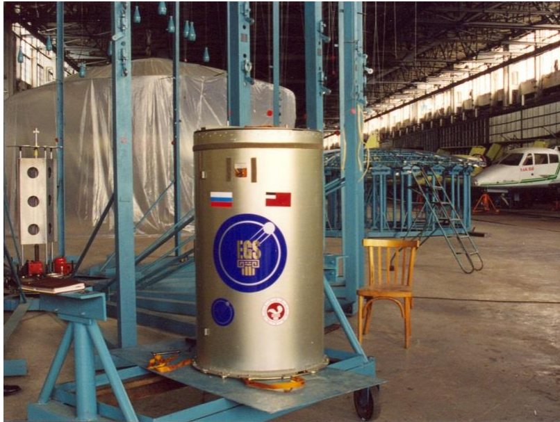
ფიგ. 76 – რეფლექტორის საფრენოსნო ვარიანტის დაკეცილი პაკეტი განთავსებულია სატრანსპორტო კონტეინერში.
