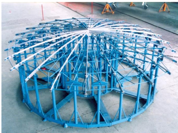
ფიგ. 48 – სტენდი, რომელზეც ცალკეული სექტორებისაგან შექმნილია შედგენილი პარაბოლოიდური გუმბათი. გუმბათის სექტორებზე ბაღვა გადაჭიმული.
