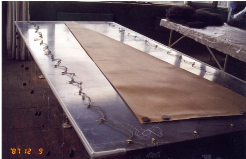
ფიგ. 44 – ბრტყელ თარგზე დადებული, გადაჭიმული ბადე, რომლის კონტურებზე საპირწონები არის ჩამაგრებული
