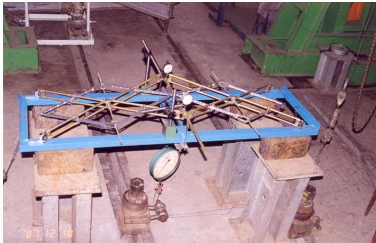
ფიგ. 37 – გამშლელი რგოლის ფრაგმენტის მექანიკური გამოცდა ზღვრულ დატვირთვაზე
