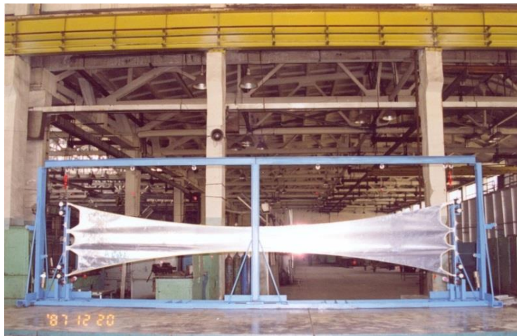
ფიგ. 41 – გაჭიმულ, დიამეტრალურად განთავსებული ფურცლოვანი წიბოების დაჭიმვის ექსპერიმენტი, ფურცლების ვერტიკალური სიხისტის წიბოებით დამაგრების გარეშე.
