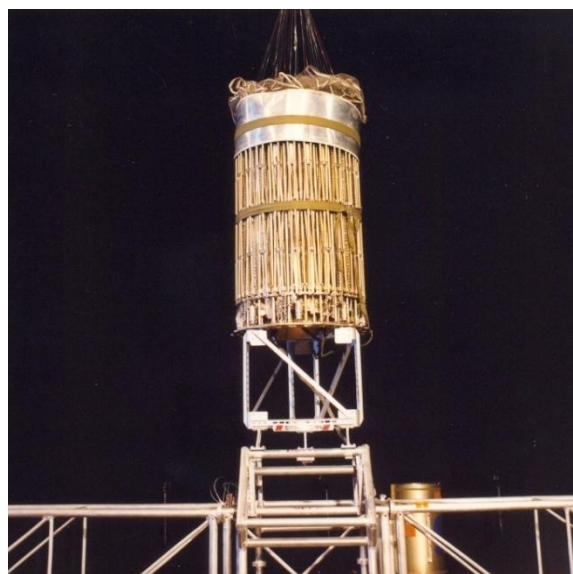
ფიგ. 66 – გრძივი, ფერმულ კონსტრუქციაზე მიმაგრებული რეფლექტორის დაკეცილი, კომპაქტური პაკეტი, ზედა სალტის და მომჭერების მოხსნის შემდეგ გაშლისათვის სრულ სასტარტო მდგომარეობაშია.
