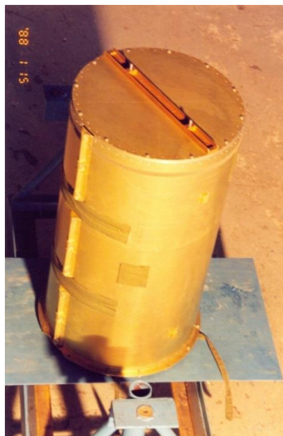
ფიგ. 61 – რეფლექტორის დაკეცილი პაკეტი განთავსებულია სატრანსპორტო კონტეინერში, რომელზეც სახურავია დამაგრებული.
