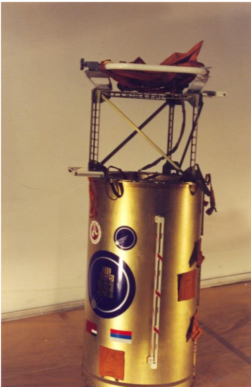
ფიგ. 63 – დაკეცილი რეფლექტორის განთავსების სატრანსპორტო კონტეინერი, მასზე მიმაგრებული სამონტაჟო სივრცით ღეროვანი სტრუქტურით, ელექტროამძრავების კაბელების ჩასაწყობი ჩანთით და მისივე ჩარჩოთი.
