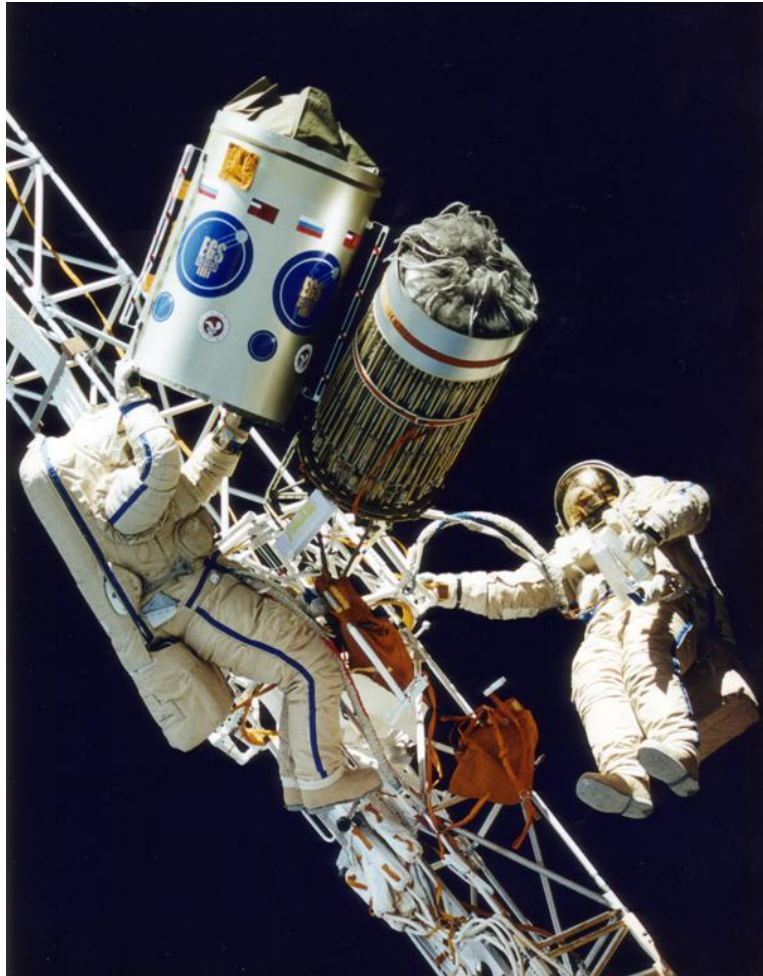
ფიგ. 109 – კონსტრუქცია “სოფორა”-ზე მყოფმა კოსმონავტებმა რეფლექტორის დაკეცილ პაკეტს მოაცაღეს გარსაცმი.
