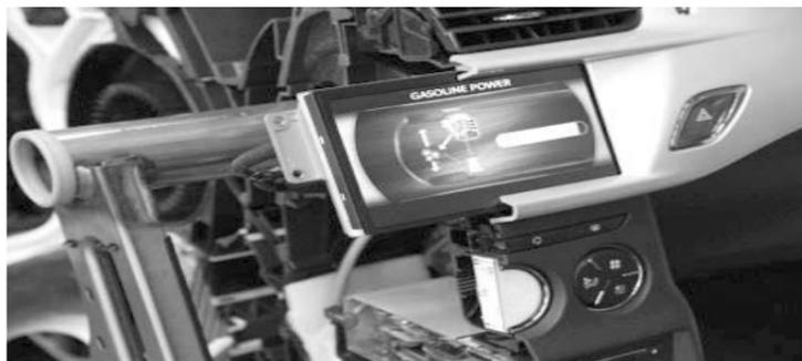
щение на колеса. При израсходовании запаса сжатого воздуха будет включаться двигатель внутреннего сгорания для его восполнения. Кроме того, запас сжатого воздуха сможет восполняться гидравлическим двигателем при торможении.
